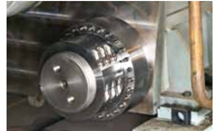
Nakrętki Superbolt kołnierza oporowego w prasach wykonywane są na specjalne zamówienie. Charakteryzują się znacznie łatwiejszym montażem i demontażem w porównaniu z innymi systemami połączeń kolumn pras.
