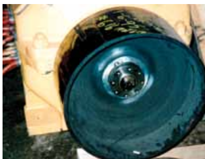
Napinacz Superbolt w napędzie młyna został specjalnie zaprojektowany do mocowania sprzęgła, hamulca i rolek do napędu młyna. Można stosować jako zamienniki do nakrętek dostarczanych przez producenta napędów.
