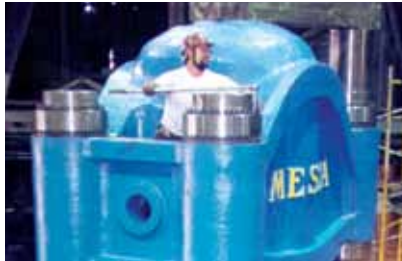
Ośmiu napinaczy kolumnowych Superbolt wymaga tylko 12 roboczo-godzin prac montażowych, w przeciwieństwie do tradycyjnych instalacji trwających do 2,5 dni.
