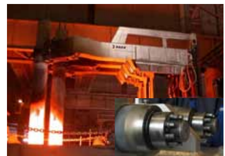
Konstrukcja zamocowania elektrody EAF. Napinacze Superbolt są wykonane, tak aby wytrzymać ogromne vibracje na konstrukcji mocującej elektrodę.
