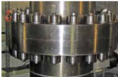
Napinacze Superbolt idealnie nadają się do zastosowań w konstrukcjach sprzęgła, jak widać na rysunku idealnie rozwiązują problem sprzęgła generator/pompa w elektrowniach szczytowo-pompowych.
