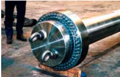
Największy na świecie napinacz Superbolt o średnicy 28" i długości 40" (711,2 mm średnicy i 12,2 m długości). Produkt ten stosuje się w dużych prasach hydraulicznych.
