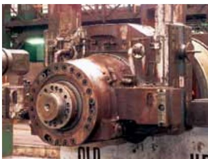
Kołnierze oporowe na wale łożyska, wytwarzają większe napięcia wstępne niż w przypadku dotychczas stosowanych metod. Dlatego nawet największe naprężenia szczytowe mogą być pochłaniane. Urządzenie jest trwale zabezpieczone i produkcja przebiega płynnie.
