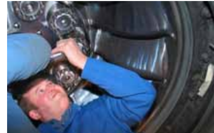
Dzięki napinaczowi Superbolt, można realizować połączenia śrubowe w najtrudniej dostępnych miejscach i skomplikowanych pozycjach do montażu. Powyższe urządzenie wymaga regularnych przeglądów, co możliwe jest dzięki zastosowaniu napinaczy Superbolt.
