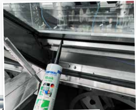
Klejenie i uszczelnianie pokrywy szklanej (maszyna do przetwarzania oliwek) Flex 310 M® Classic
